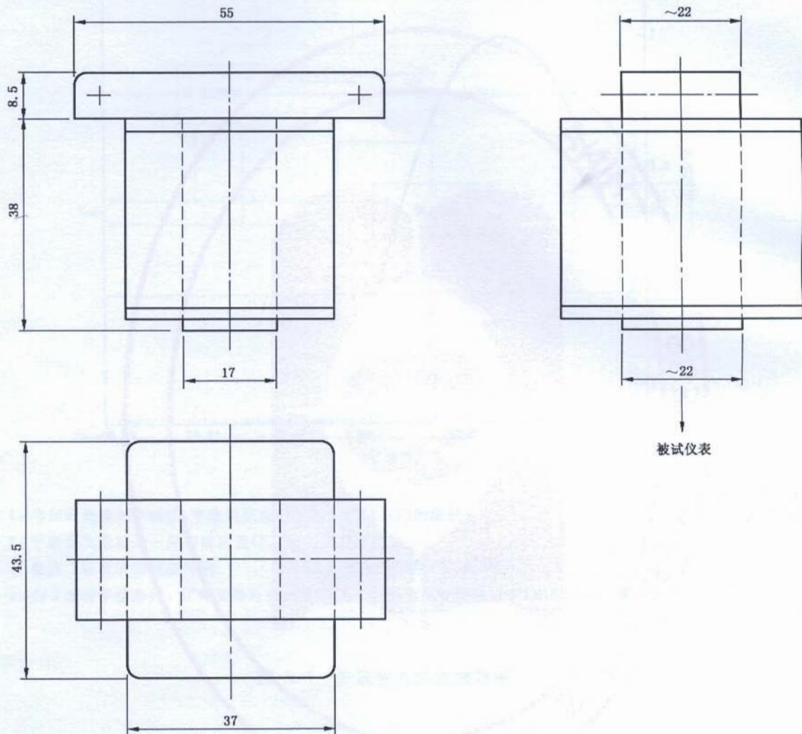
绕组参数举例:500 匝  $\phi 0.6 \text{ mm}/0.28 \text{ mm}^2$
